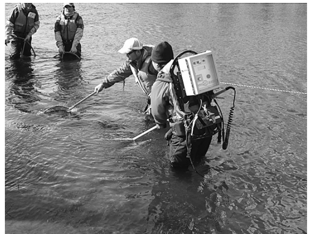
写真3. 調査道具の説明を受けている風景。定置網（右上）、さで網（左下）及びエレクトロフィッシャー（右下）。
