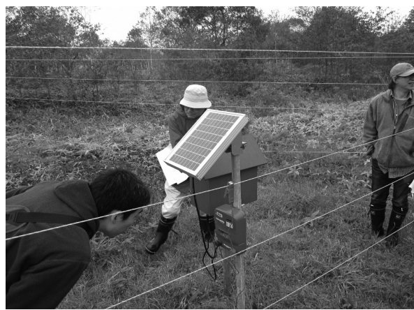
ソーラー電源によるシカ除け用電柵
