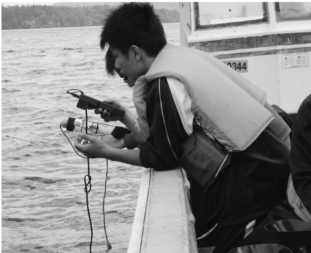
電気伝導度やpHなど水質を測定
