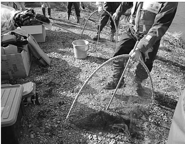
写真3. 調査道具の説明を受けている風景。定置網（右上）、さで網（左下）及びエレクトロフィッシャー（右下）。
